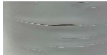
ひび割れてめくれた部分を削った状態
